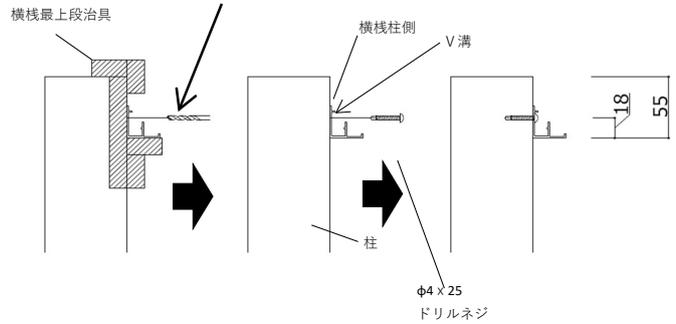
③最上段の横棧柱側を、 $\phi 4 \times 25$ ドリルネジで取付けてください。
