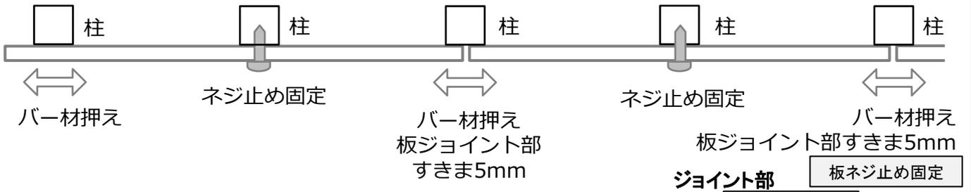
② 『バー材押え』（板ジョイント）部分には『バー材（押え材）』を用いて取付してください。
