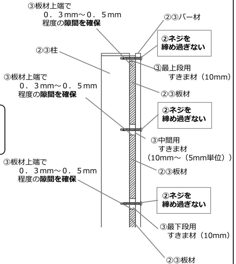
④バー材を取付するネジは、すきま材の中央でネジ止めしてください。
