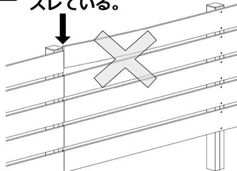
⚠ 柱をねじれ状態で施工している。
