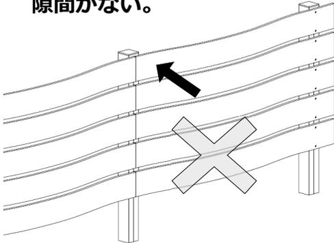
⚠ 柱上部の板を、最上段用すきま材（10mm）なしでネジ止め固定している。
