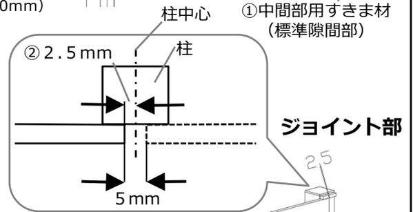
③左から2本目の柱中心に板本体をφ4×35ドリルネジでネジ止めします。(※45サイズ板は中央にネジ1本止めです。)
