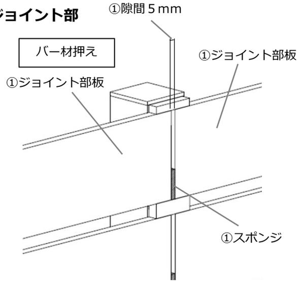
②バー材押え部の取付けネジは仮止めとし、全体の確認後に、締め過ぎない程度に本締めしてください。
