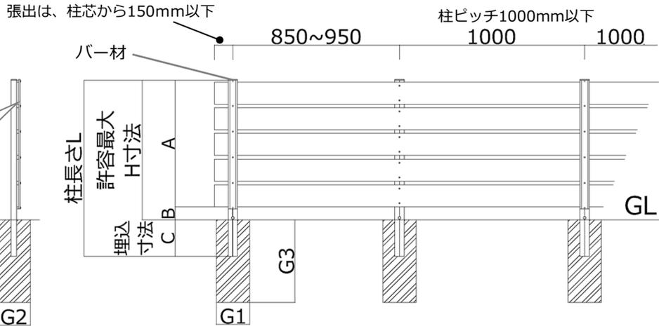
※下記は隙間(すきま材) 20mmで施工時の寸法です。
