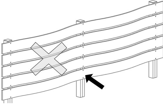
⚠ バー材押え部の板をネジ止め固定している。
