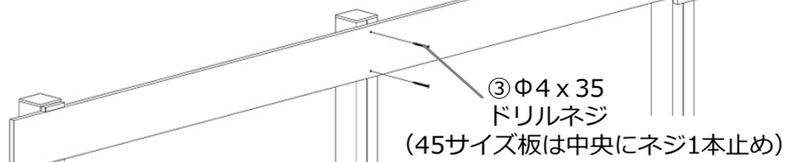
④左から1本目の柱中心にバー材をφ4×35ドリルネジで仮止めします。
