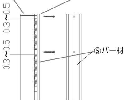
⑥中間部用すきま材貼付後、2段目板本体をφ4×35ドリルネジでネジ止めします。(※45サイズ板は中央にネジ1本止めです。)
