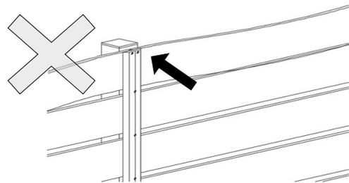
⚠ バー材押え部の一部が隙間不良となっている。
