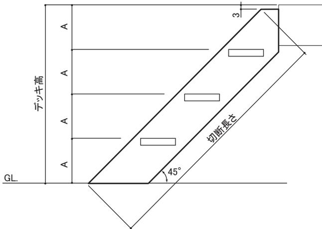
注1) 切断長さ=(デッキ高-3)×約1.41で切断してください。
