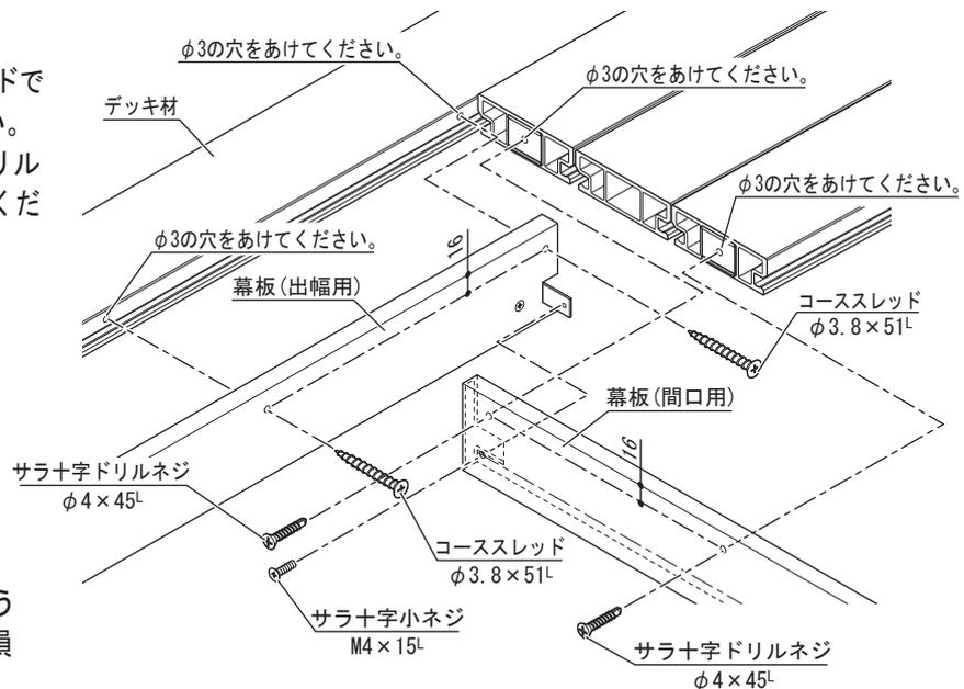
注) ビスを締め付け過ぎないようにしてください。幕板Aの破損や緩みの原因になります。
