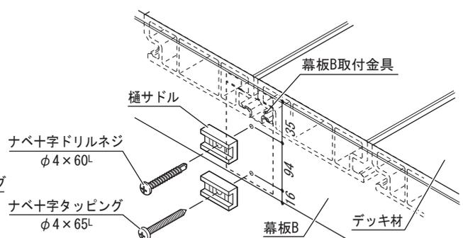
注1) デッキ正面に取り付ける場合、幕板を固定しているビスの直近に取り付けてください。
