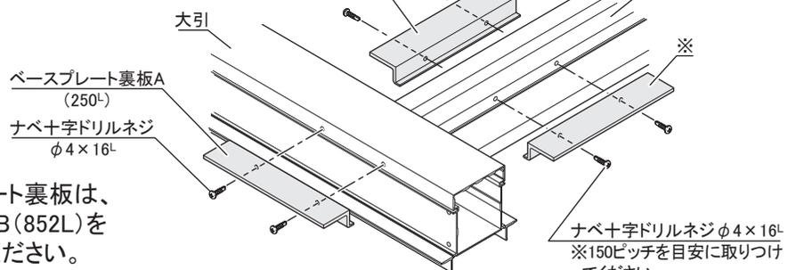
注) ※印のベースプレート裏板は、ベースプレート裏板B(852L)を2分割して使用してください。
