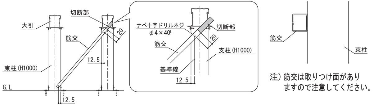
2. 出幅方向は筋交A、間口方向は筋交Bを加工し、筋交キャップを取りつけてから取り付けてください。
