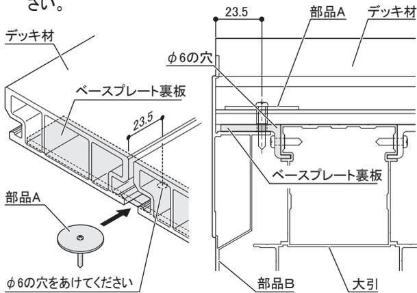
注) ベースプレートを止める六角ドリルネジ(φ6×80<sup>L</sup>)と干渉する場合は、幕板取付金具Bにφ6の穴をあけてから取りつけてください。
