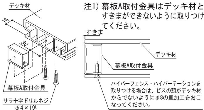
注2) 幕板A取付金具は、幕板A(18)で5個、幕板A(27)で7個、幕板A(45)で12個使用します。下図を参考にデッキ材2つおきを基本に均等になるように取り付けてください。
