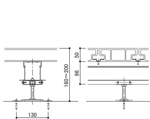
2-9. ベースプレートL 正面側取り付け納まり図
