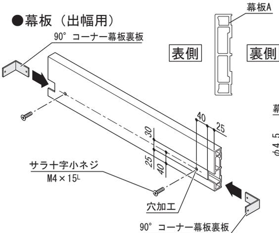
幕板Aをデッキ切断寸法Aで切断し、表側の板のみ、25×30の大きさに切欠いて、90° コーナー幕板裏板を取りつけてください。
