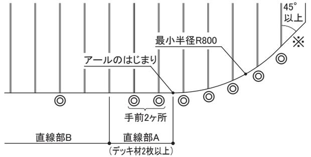
注1) 斜めカットの場合は、斜め面の始まりと終わりに、アールカットの場合は、アールの終わりに幕板B追加固定金具を取りつけてください。その場合、デッキ材中央の中空部に取りつけてください。
