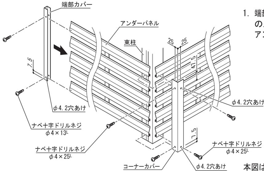
1. 端部カバーの下部、コーナーカバーの上下部にφ4.2穴あけを行い、アンダーパネルに固定してください。
