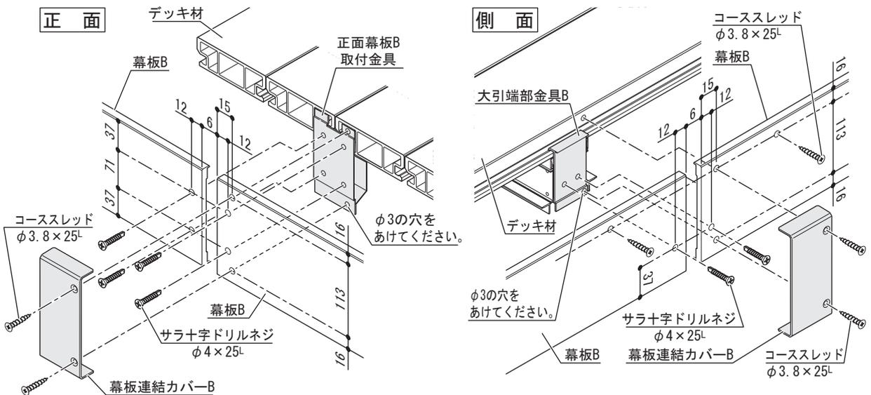
注) 幕板連結部は6mmのすき間をとり、幕板連結カバーBを一方の幕板Bにコーススレッドで取りつけてください。
