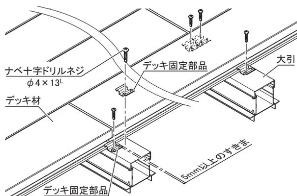
注) デッキ材は1本の大引で連結せず、2本以上の大引に分けて連結してください。
