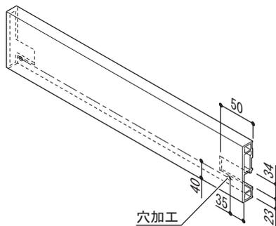
幕板Aを仕上り寸法Bで切断し、裏側の板のみ、50×34の大きさに切欠いて、表側にのみ、φ4.5・φ8サラモミの穴加工をしてください。
