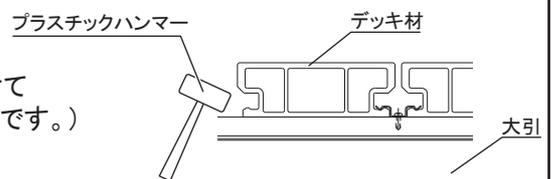
※側面大引間にフェンスがつく場合はデッキ補強材を取りつけてください。(デッキ材凹部に差し込むだけで、ビス止めは不要です。)
