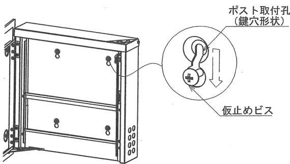
①ポスト本体の取付孔4か所（鍵穴形状）を仮止めしたビスに引っかけ、仮置きしてください。
