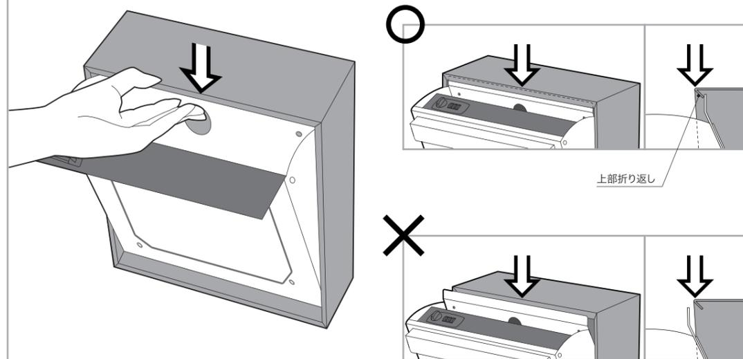
2 背面パネルと扉内部の背面側を合わせて、上側の穴2ヶ所にナイロンプッシュリベットを差し、押し込んで止めます。
