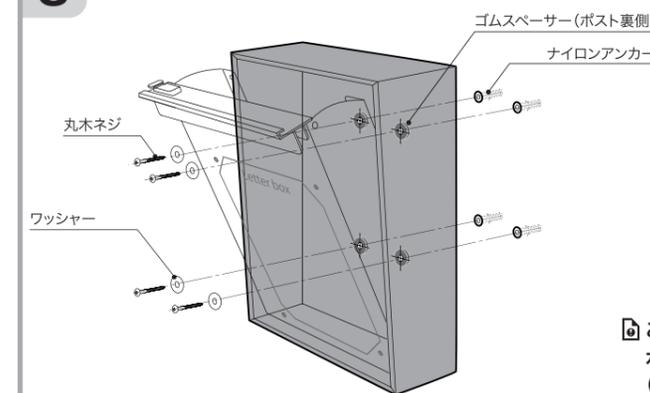
この時、扉がきちんと本体に収納されるか、水平・垂直を確認しながら取付けてください。(壁面の歪みをネジの締め付けの強弱で補正します。)
