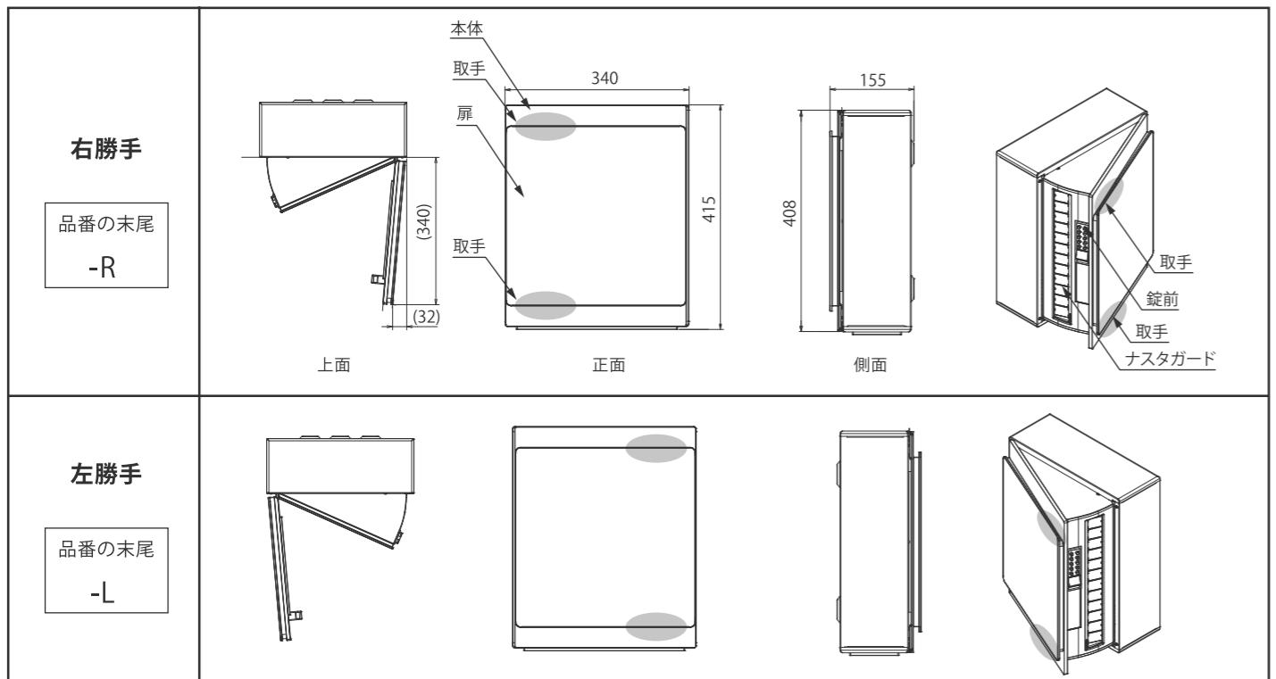
**扉の開閉方法** 扉の開閉は取手に手を添えて開閉してください。(上図 グレー部分)
