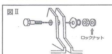
③連結用の穴に左側からボルトを通し、次に連結したボルトの先に左側から、ワッシャー・スプリングワッシャー・普通ナットの順に通し、最後にロックナットを通して下さい。（※図II参照）
