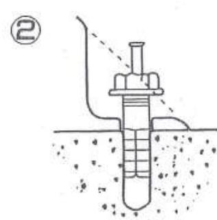
孔内の切粉を除去して、アンカーの座金(ナット)が取付物に接するまでアンカーを挿入してください。
