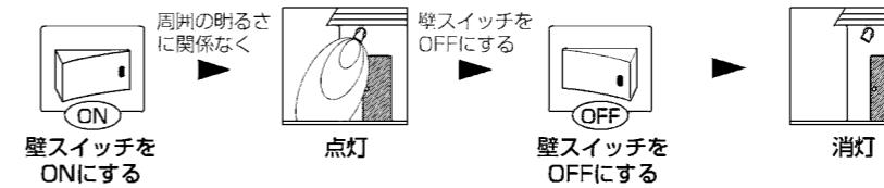
※電源投入後、約50秒間点灯し、その後センサ待機モードになります。人を感知するごとに点灯時間が延長しますが、電源投入から約60秒後に一旦消灯し、センサ待機モードになります。(連続点灯モードを除く。)
