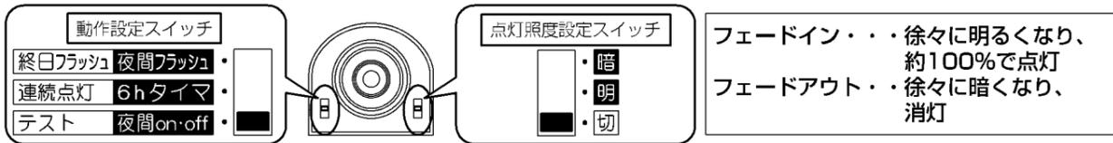
①電源投入後、約20秒間点灯し、その後は明るくても人を感知することに約5秒間点灯します。結線および負荷の動作を確認できます。
