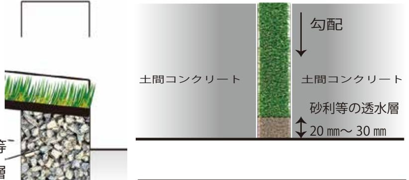
【水勾配先端部の断面図と上面図】
