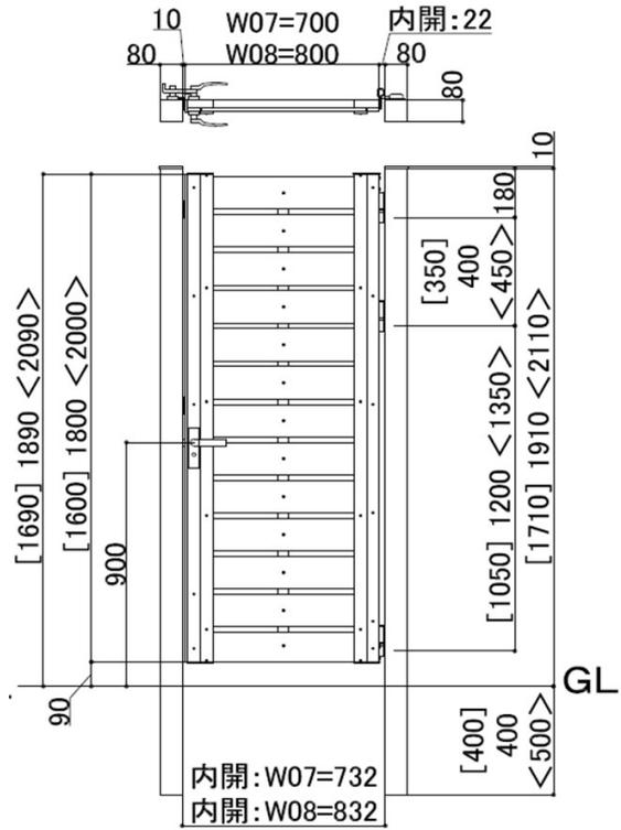
内開きと外開きで、吊元柱の持ち送り取付面の方向が異なります。吊元柱の埋込向きを確認してください。図は外観右吊元を示します。外観左吊元は対称となります。この仕様は内開きとなります。
